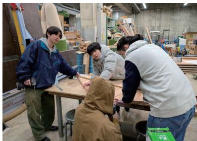
図6 パネルの枠材の取り付け
