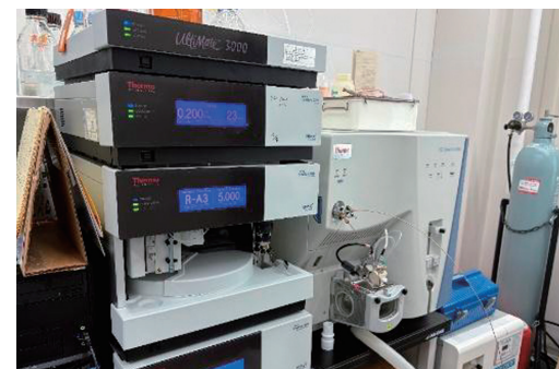
図2 馬尿酸とニコチアナミンの測定に用いた液体クロマトグラフィー質量分析計(LCMSMS)
