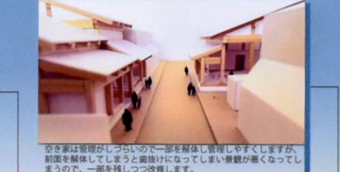
空き家は管理が難しいので一部を解体し管理しやすくしますが、前面を解体してしまうと面抜けになってしまう景観が悪くなるので、一部を残しつつ改修します。
