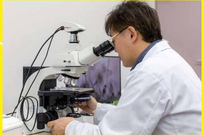
麹菌が米粒上で生育している様子を観察しています。これは実体顕微鏡といい、物体の表面を観察することが出来ます。大学には電子顕微鏡もあり、これを使うと穀粉粒子を溶かしながら伸張していく菌糸の様子も観察できます。
