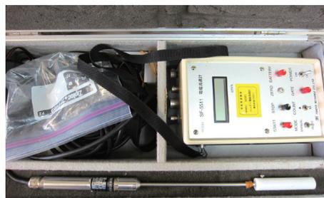
図4 使用した流速計
