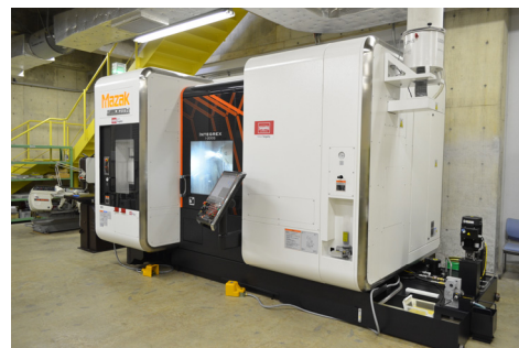
複雑な加工ができる同時5軸制御加工機で加工が難しい材料を高精度で能率良く加工します。
