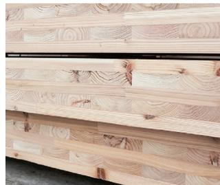
スギを用いて製造された5層構成のCLT
