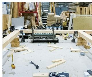
安価な接合具を用いた木質フレームと接合具の例
