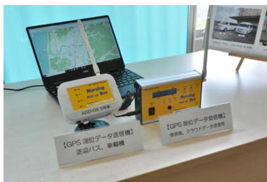
図 3-2. 開発した位置情報送信機・受信機
