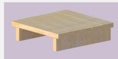
7枚組のKAPLAを1単位とし、これを繰り返す構造物を組み立てる
