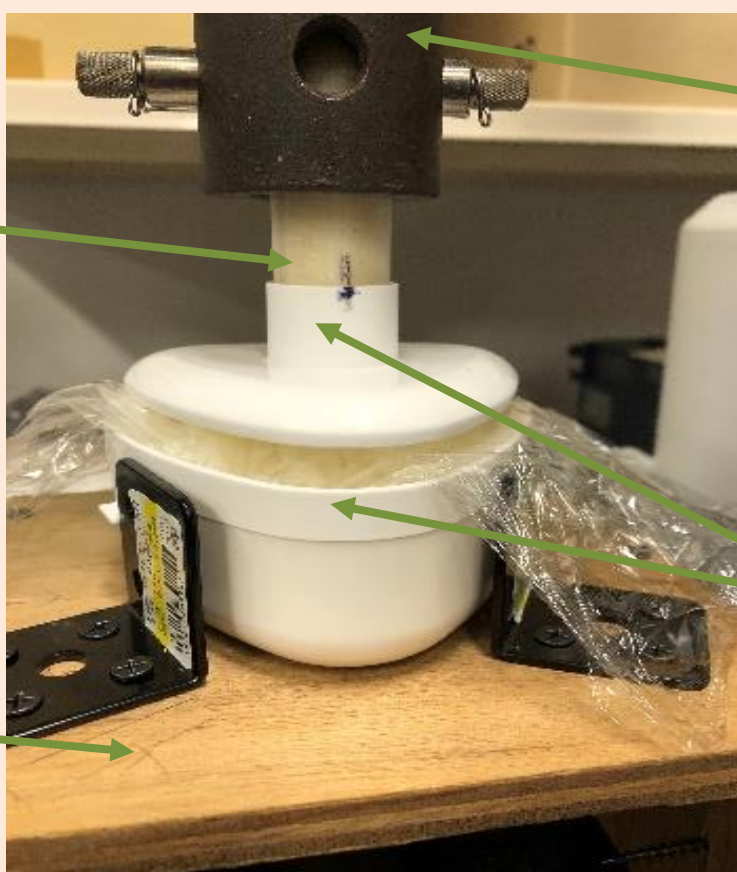
図 自作したおにぎり圧縮成形治具の外観
