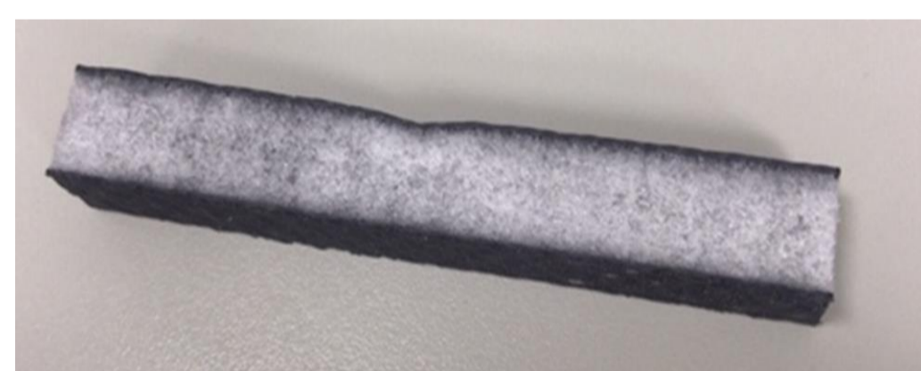
図5-1 フォーマックコアのサンドイッチパネル
