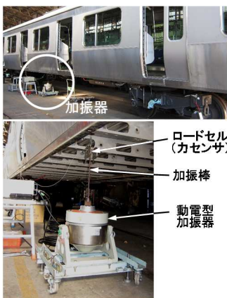
図4 車体の定置加振試験 (1)
