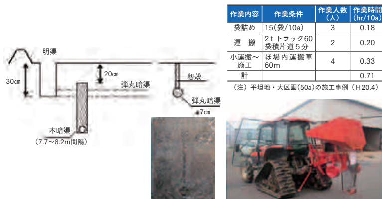
図2-1 籾殻補助暗渠機（試作機）
