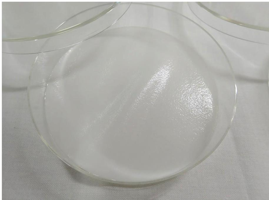
水(水道水でもOK)を少し多めに入れ、ろ紙に吸収されない余分な水は捨てる。
