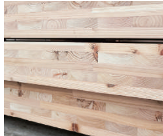
スギを用いて製造された5層構成のCLT
