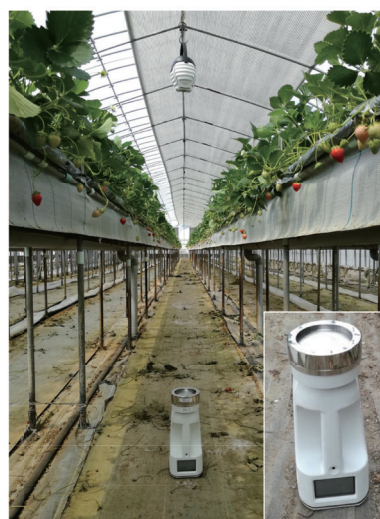
図11. エアサンプラーによるイチゴうどんこ病菌分生子の捕集と検出 (左:検出手順、右:エアサンプラー設置の様子)
