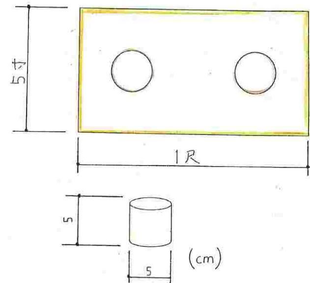
開口部などは全てブロックの中に埋め込まれているため、自分の好きな位置に取り付けることができます。主なブロックとしては、壁用・壁用の半分の材・屋根勾配用・玄関戸・部屋戸(引き違い戸)・部屋戸(片開き戸)・窓(大)・窓(小)・換気扇…などがあります。これさえあれば壁としてだけでなく、仮設住宅も完成し、被災者は快適な生活も送ってしまうのです。
