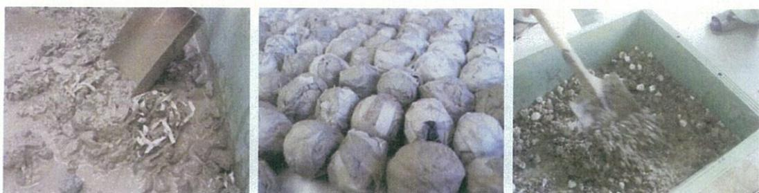
図4. そのままダストを導入した様子 図5. 団子状にしたシュレッダーダスト 図6. ダストの団子を混練中
