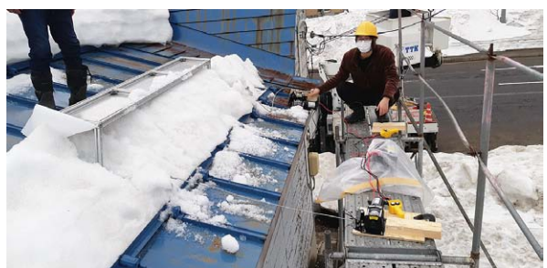
図 4：引張試験時、固定木材が破断した際の写真
