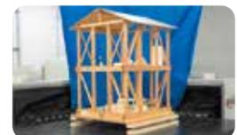
○免震装置の原理模型を用いた振動台実験の様子
