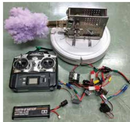
図4 試験狭所掃除ロボットと関連機材一式
