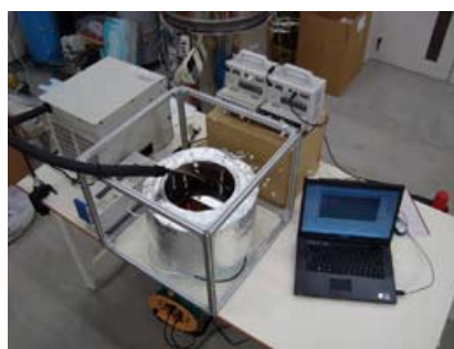
バイオディーゼル燃料の低温特性実験
