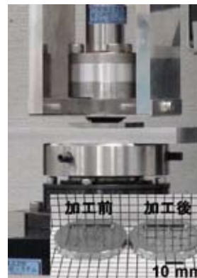
金型の磁場援用鏡面研磨 自転/公転型研磨機の試作機
