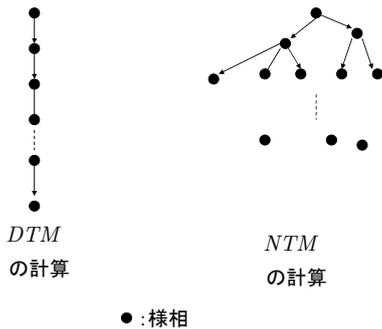
DTMによるNTMのシミュレーション
