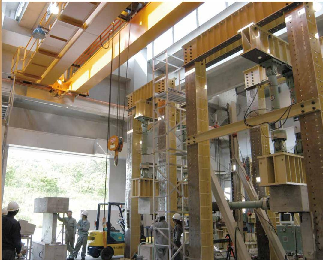
特別実験棟の大規模構造・材料実験設備
