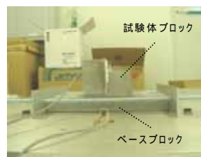
Fig.14 振動実験試験体
