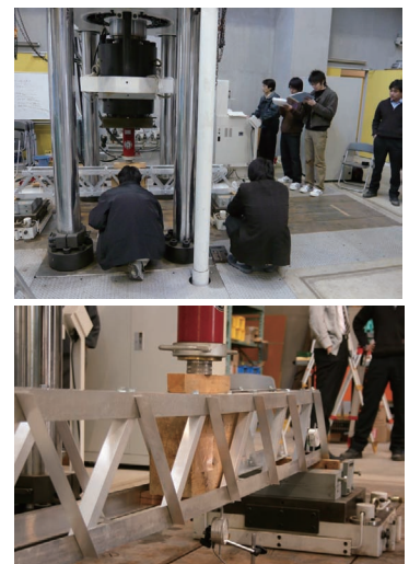
トラス梁の載荷実験の様子
