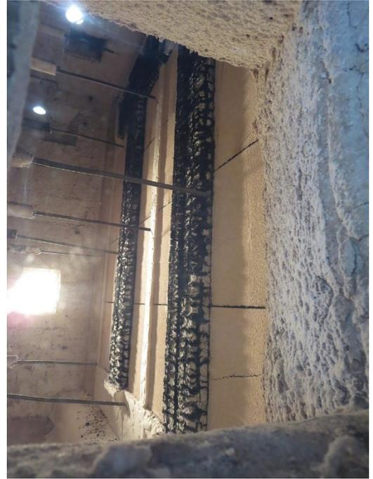
写真 18 試験開始 100 分時の状況（加熱側）
