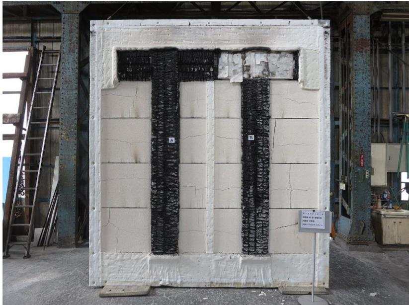
写真 22 試験後の状況（加熱側）
