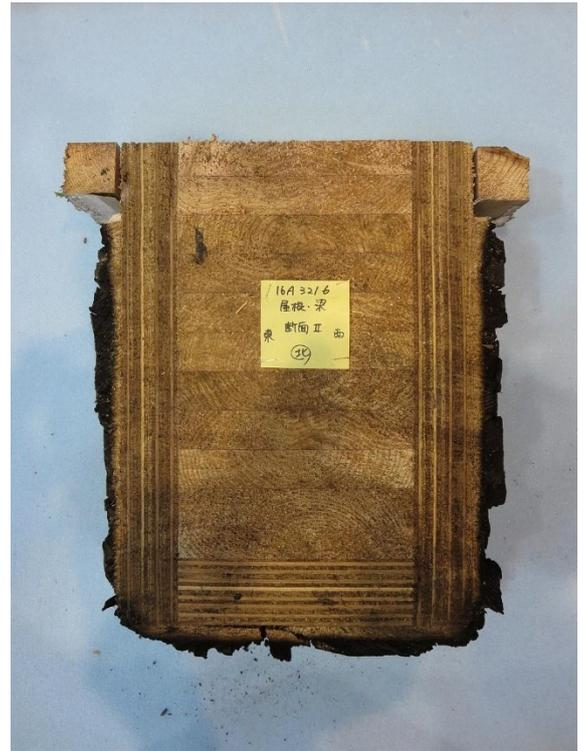
写真 26 試験後のはり：荷重支持部材の状況
