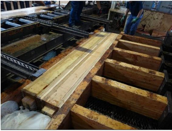
図 3-8 手締めプレスによる梁の4次接着
