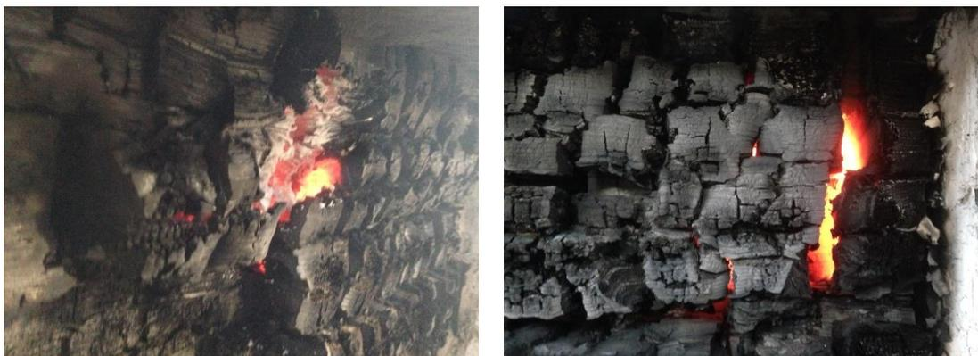
図 4-21 赤熱状況(左：仕様 I-2 制御室側中央付近 右：仕様 L-2 制御室側隅部)
