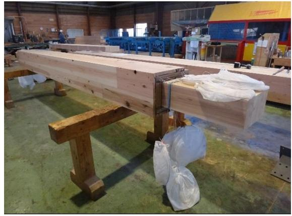
図 3-9 梁試験体
