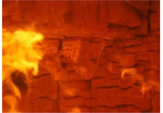
写真 5-3-2 加熱状況 (接合 B: プレース落下後)
