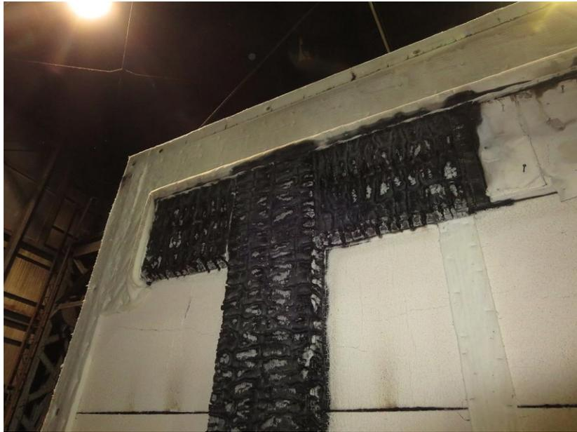
写真 20 脱炉直後（試験開始 720 分経過後）の A 部接合部の状況（加熱側）
