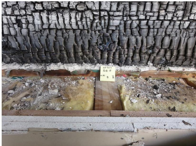
写真 18 試験後の試験体・屋根内部の状況（加熱側：東）
