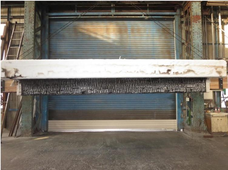
写真 14 試験後の試験体の状況
