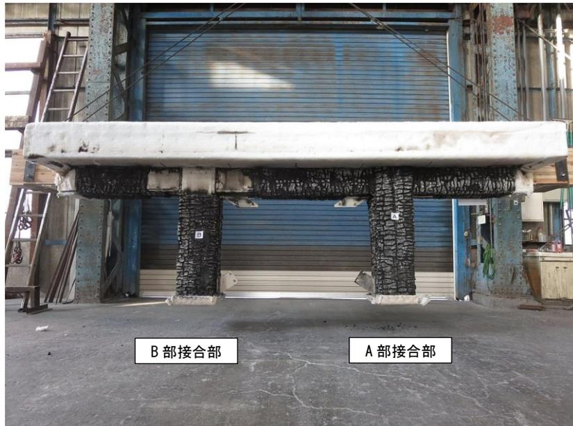
写真 25 試験後の試験体の状況（西側）
