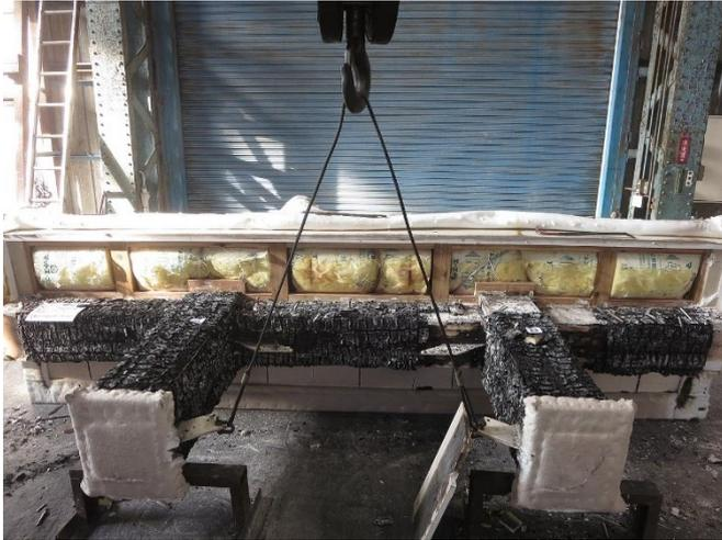
写真 39 試験体：床屋内側内部の状況（東側）
