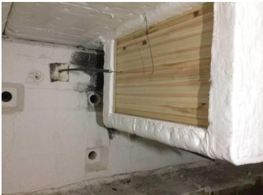
图 4-11 炉内狀況(試驗体 L-2)
