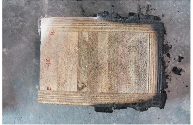
写真 5-3-9 柱残存断面
