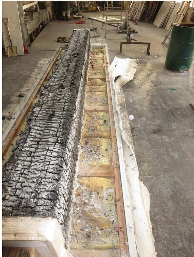
写真 17 試験後の試験体・屋根内部の状況（加熱側：東）
