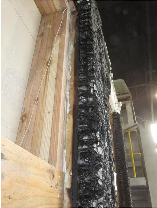
写真 27 A部接合部：壁・柱取合部の状況
