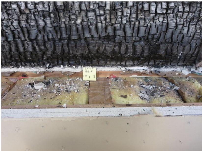
写真 20 試験後の試験体・屋根内部（加熱側：東）の状況
