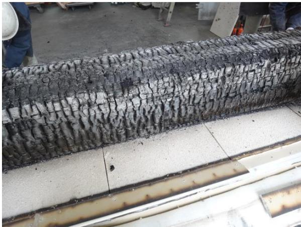
写真 5-2-3 脱炉後試験体状況
