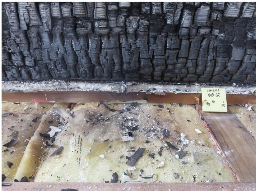
写真 24 試験後の試験体・屋根内部（加熱側：西）の状況
