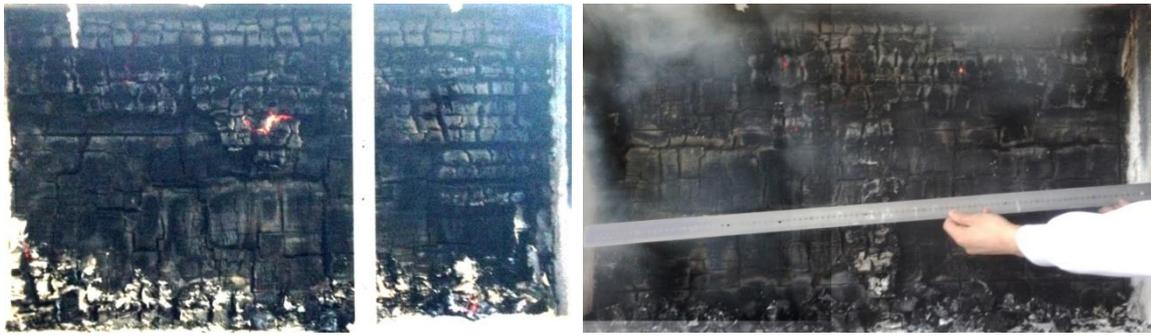
図 4-18 試験体 I-2 脱炉後(左：制御室側、右：煙突側)
