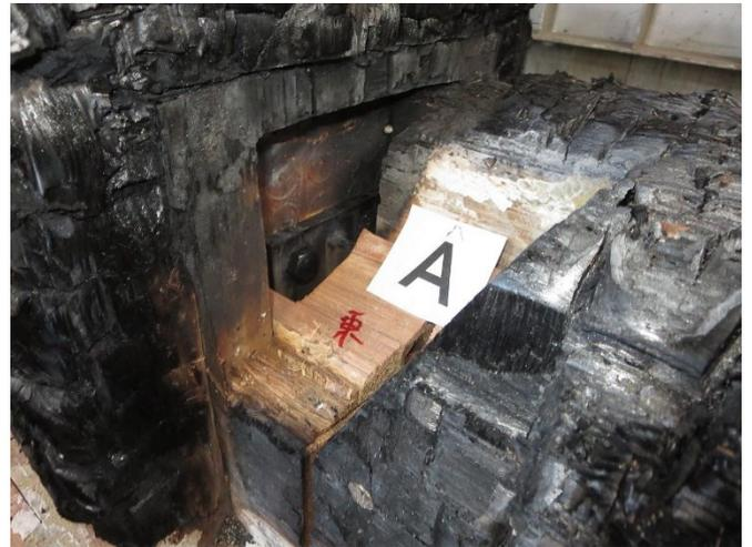
写真 42 A 接合部：柱・はり接合金物
