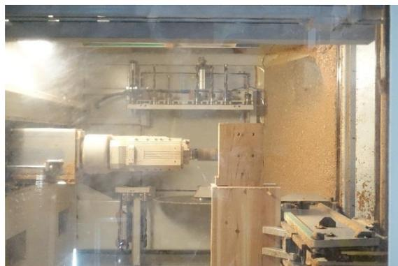
図 3-7 NC 加工機における加工
