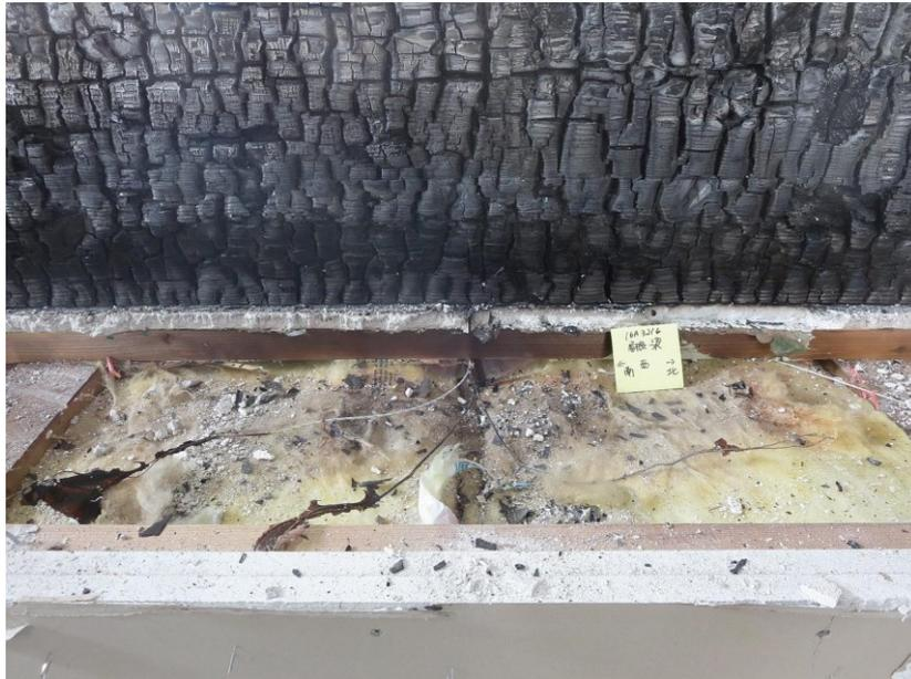
写真 23 試験後の試験体・屋根内部（加熱側：西）の状況
