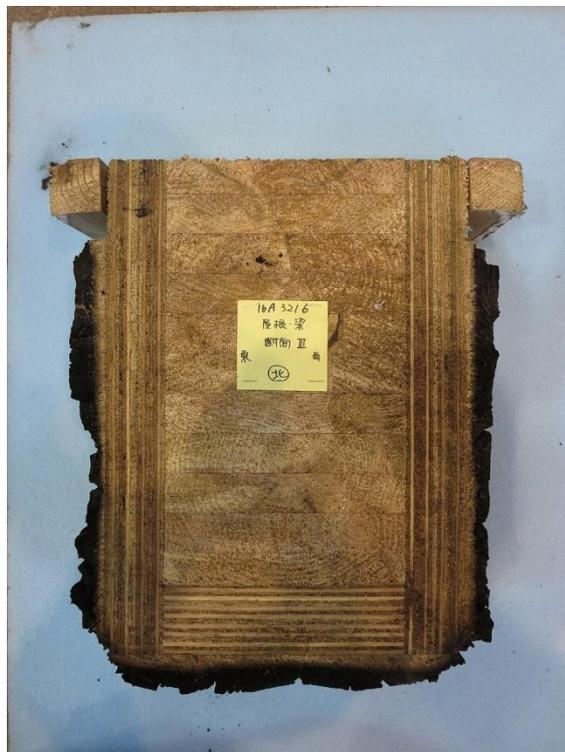
写真 27 試験後のはり：荷重支持部材の状況 (断面Ⅲ)
