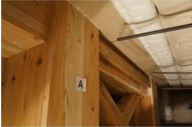
写真 5-3-1 試験体炉内設置状況
