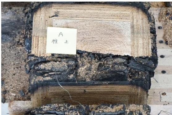
写真 5-1-12 A 柱上段部 切断面
