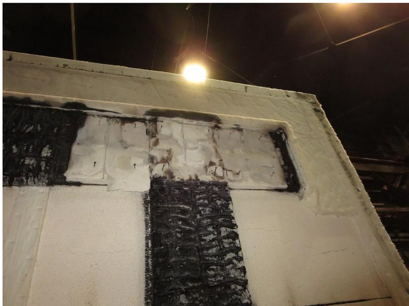
写真 21 脱炉直後（試験開始 720 分経過後）の B 部接合部の状況（加熱側）
