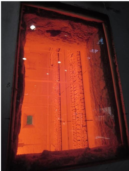
写真 15 試験開始 54 分時の状況（加熱側）
