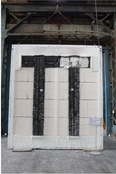
写真 5-1-8 試験体 (脱炉)
