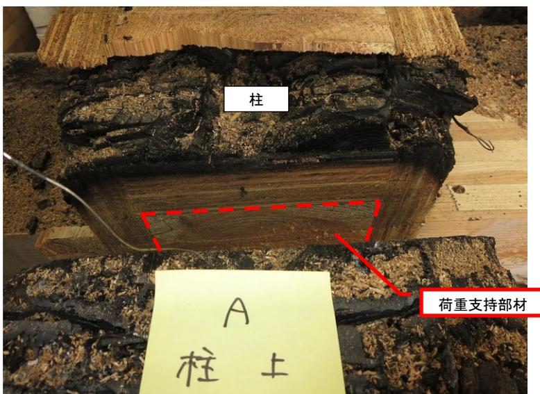
写真 43 A部接合部：柱一般部（上部）荷重支持部材の状況
