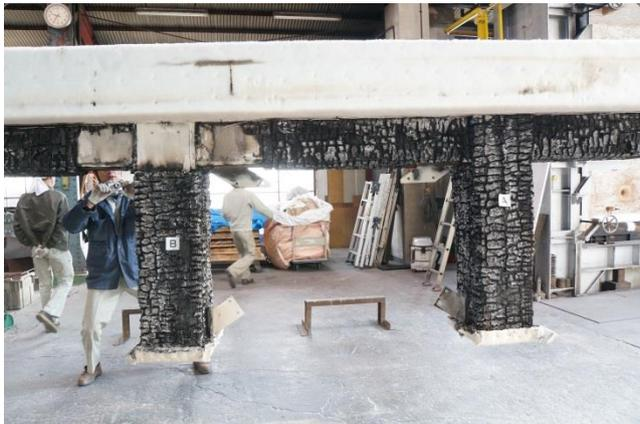
写真 5-3-3 脱炉後試験体状況
