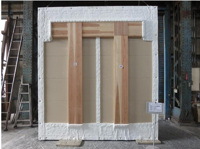
写真7 試験前の状況（加熱側）
