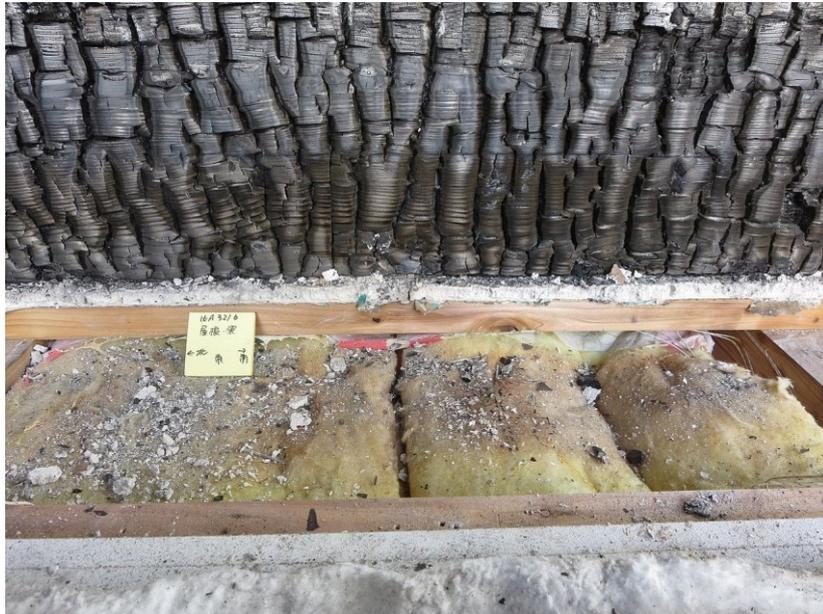
写真 19 試験後の試験体・屋根内部（加熱側：東）の状況
