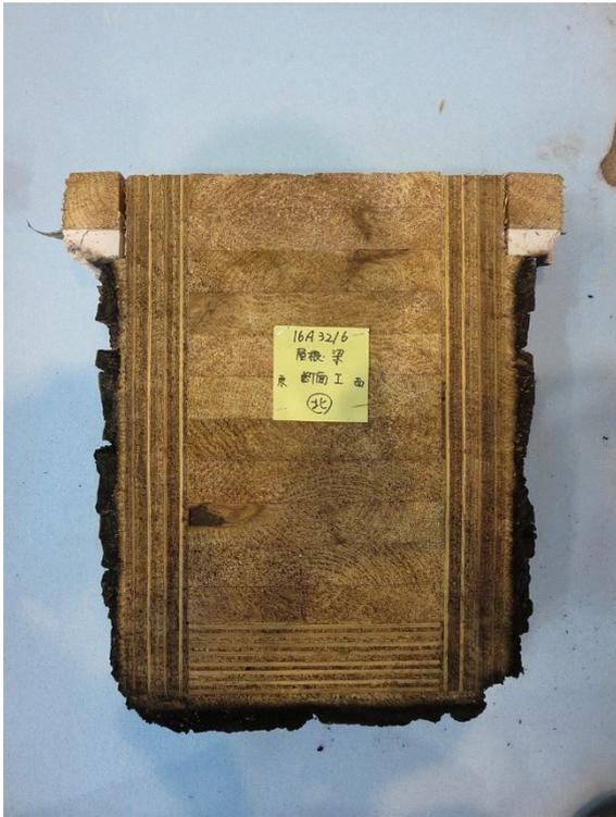
写真 25 試験後のはり：荷重支持部材の状況
