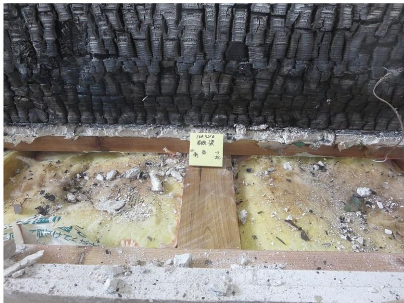
写真 22 試験後の試験体・屋根内部（加熱側：西）の状況
