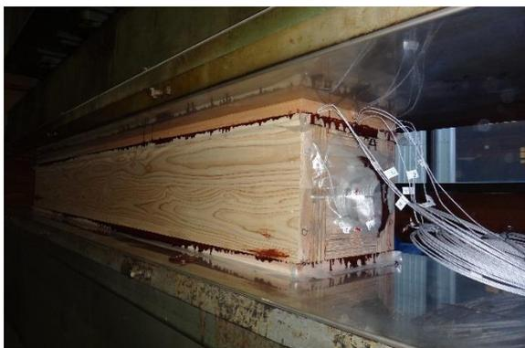
図 3-4 水平プレスによる柱の 4 次接着
