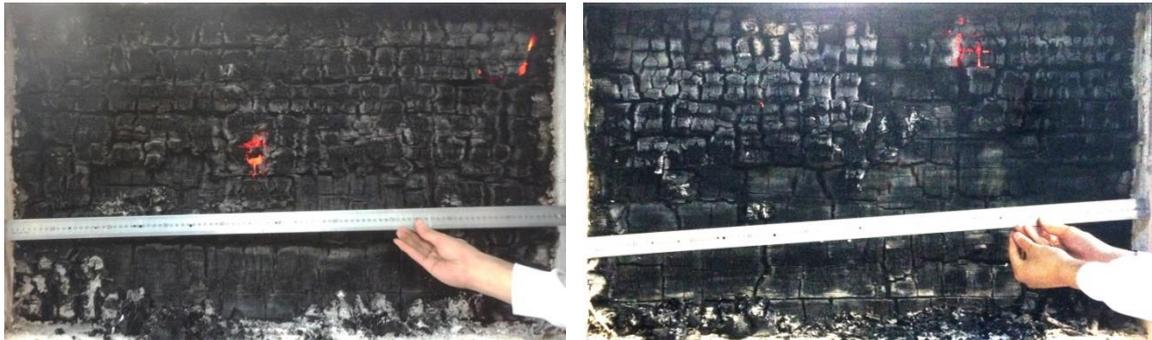
図 4-19 試験体 L-2 脱炉後(左：制御室側、右：煙突側)
