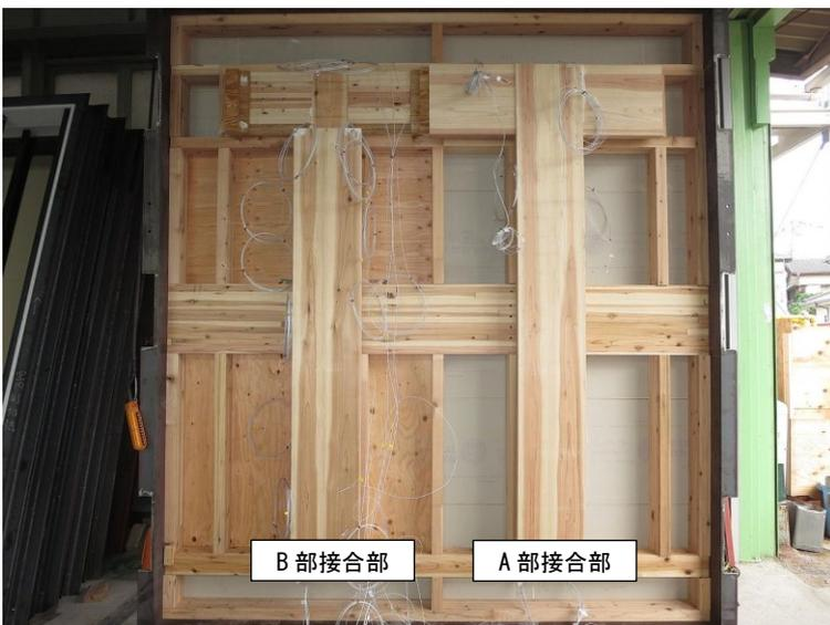
写真6 試験体内部（裏面側）
