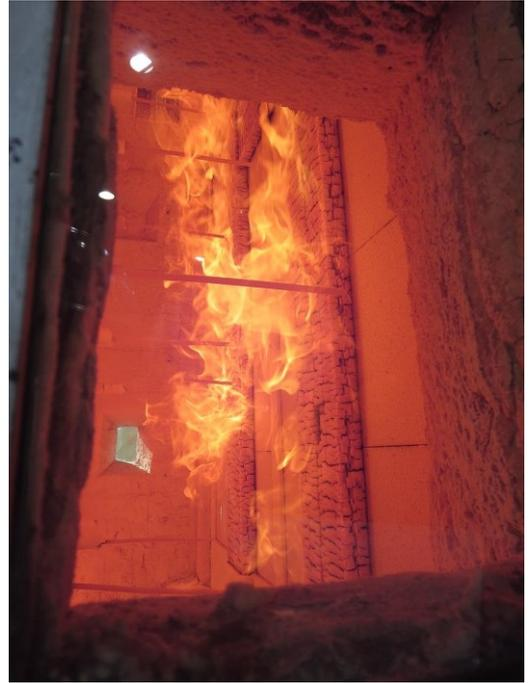
写真10 試験開始 20 分時の状況（加熱側）
