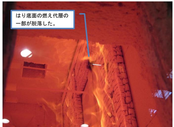
写真12 試験開始 38 分 30 秒時の B 部接合部（はり）の状況（加熱側）
