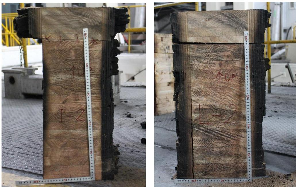
図 4-23 鉛直方向炭化状況 (左 : 試験体 I-2 右 : 試験体 L-2)
