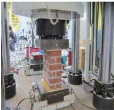
荷重試験器に設置された試験体
