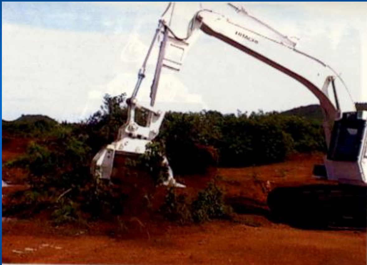
Fig.21 ロータリカッタによる粉碎処理技術(日本)
