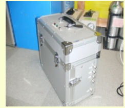
図4 二酸化炭素を高精度で計測する非分散型赤外分析計(NDIR)
