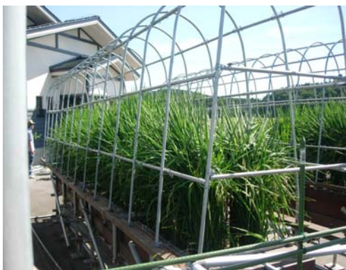
秋田市の農業集落排水処理施設内に設置したBGF水路を用いた水質浄化試験
