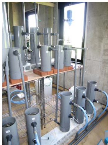
天然鉱物資材を用いた農業集落廃水二次処理水の窒素・リン除去試験 (秋田市農村振興課との共同研究)
