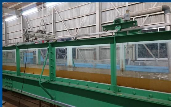
図-2 使用した実験水路
